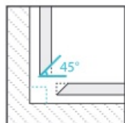
Запил для внутреннего прямого угла под 45°
